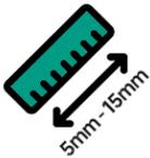
**Empfohlene Körnung:** es wird empfohlen, dass die Körnung der zu agglomerierenden Materialien zwischen 5 und 15 mm liegt, wobei zu beachten ist, dass bei kleineren Körnungen die Festigkeit der agglomerierten Masse nach dem Aushärten höher und die Drainage geringer ist, während bei größeren Körnungen das Gegenteil der Fall ist.
